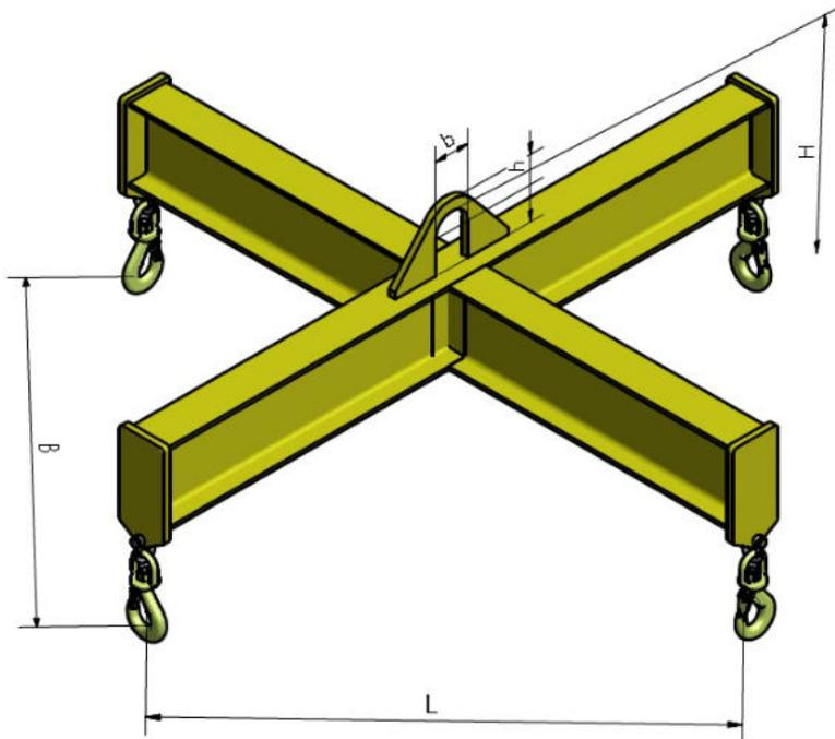
Die Kreuztraverse SKT hat zur Lastaufnahme 4 Wirbellasthaken (nicht unter Last drehbar).
