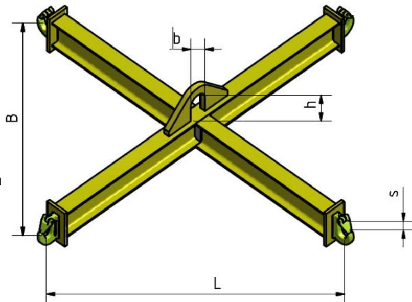
Die Aufhängeöse ist passend für Lasthaken nach DIN 15401.
